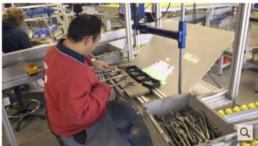
Eine auf die Werkbank projizierte Figur zeigt die Montageschritte an. (Foto: oh)
